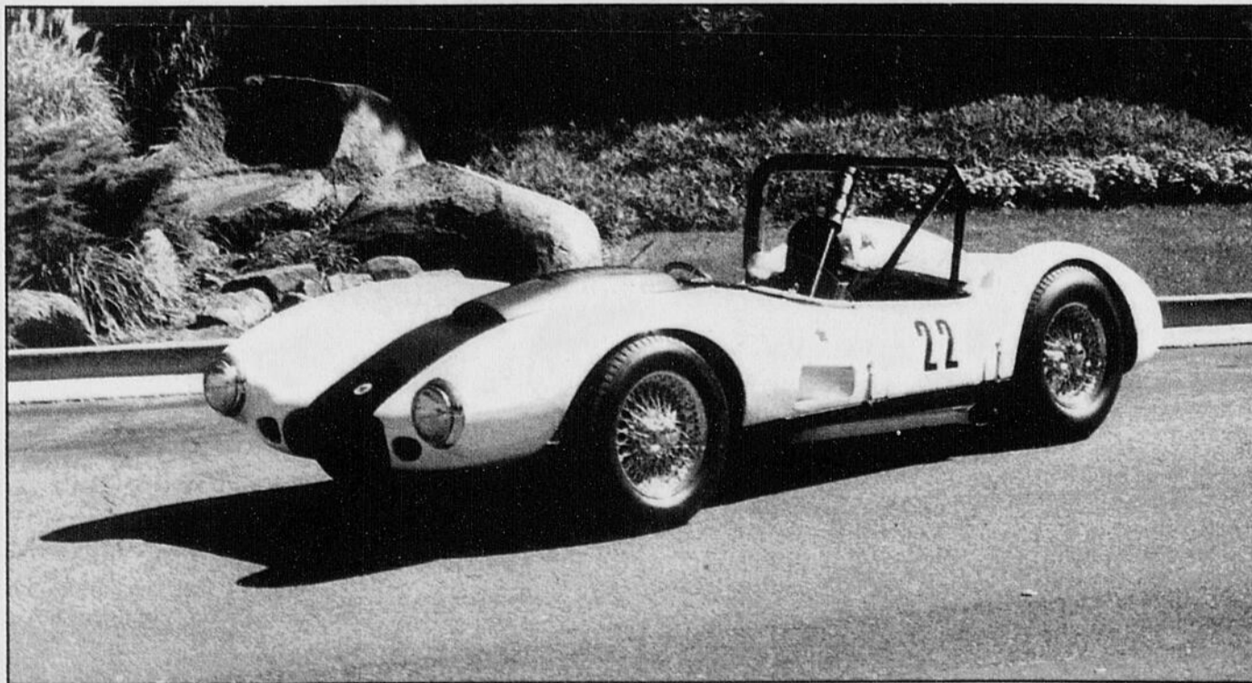
Cette Sabler 1957 a un moteur V-8 cylindres, 283 pouces cubes, puissance 400 chevaux. Sa transmission est manuelle 4 rapports. Prix actuel: valeur inestimable.
