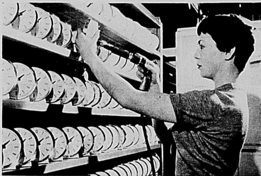
Internal, mais si commode, petit engin, symbole de la vie active du 20 e siècle: le cadran réveille-matin! L'une des 600 employées de la fabrique de Peterborough monte à l'aide d'un outil électrique spécial, des centaines de cadrans dont l'exactitude sera vérifiée pendant plusieurs jours avant d'être lancés sur le marché canadien.
