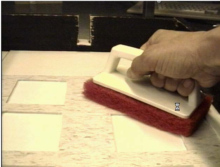
Figure 23 : Montage expérimental et brosse utilisée pour le nettoyage manuel agressif.
