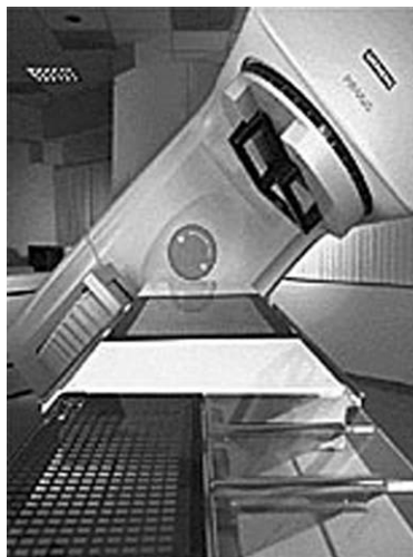
Figure D.2 Accélérateur linéaire à collimateur multilames 3D intégré (PRIMUS Linear®)
