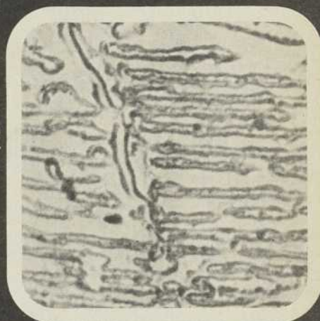
Figure 2 — Micrographie électronique d'un acier refroidi très lentement.
