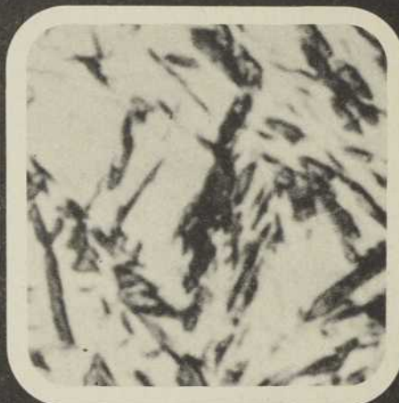
Figure 3 — Micrographie optique d'un acier refroidi très rapidement (trempe).
