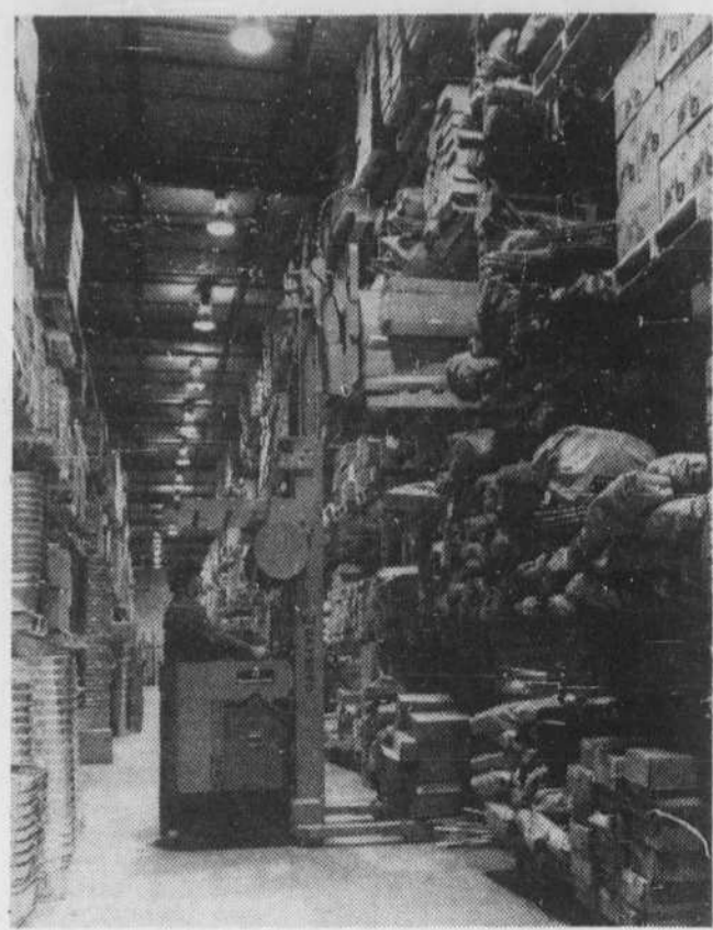
L'entrepôt de Ro-Na est l'un des plus automatisés au Québec. Il est équipé de 250 chariots sur minirail qui sillonnent les quatorze sections de l'entrepôt avant de se retrouver tous au service de l'expédition. Sur la photo, l'un des dix chariots-élévateurs à l'ouvrage. L'entrepôt qui mesure 26 pieds de hauteur s'étend sur une superficie de plus de 160,000 pieds carrés.
