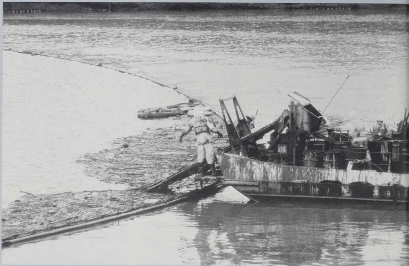
Après avoir été confiné par les estacades, le pétrole est récupéré au moyen d'un lèche-nappe.
