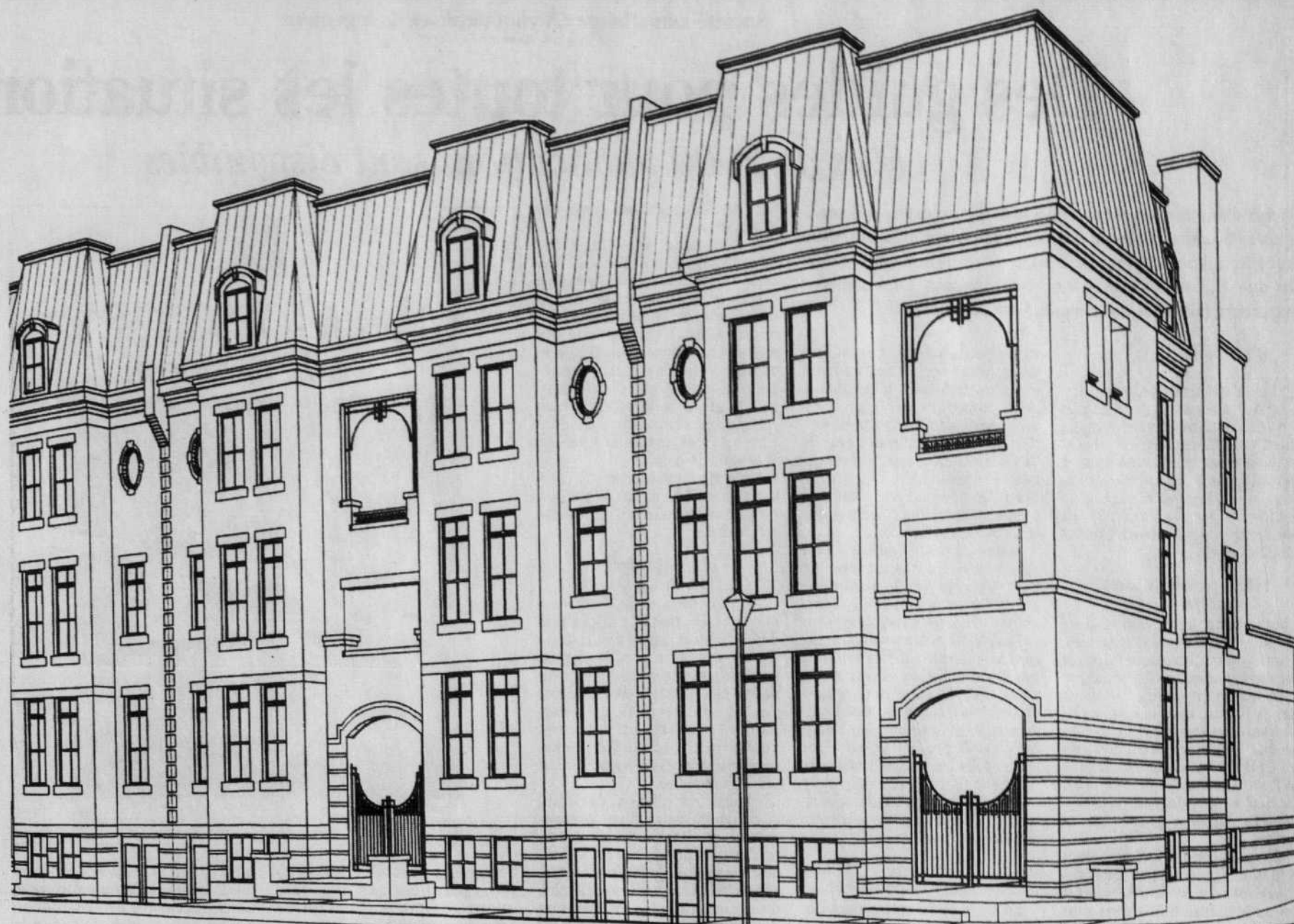
Le Jardin en ville compte 79 unités, soit 4 à 8 unités par immeuble, regroupées autour d'un escalier central de type loggia italienne, ouvert sur l'extérieur.
