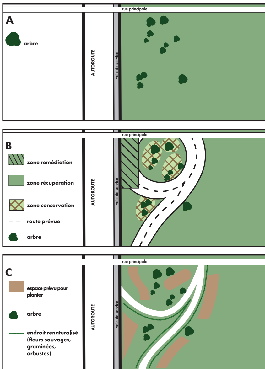
Fig. 7 Exemple d'interventions de conservation et de remise en état dans le cadre de la construction d'un échangeur : A) Situation initiale, B) Interventions de remise en état, C) Résultat final
