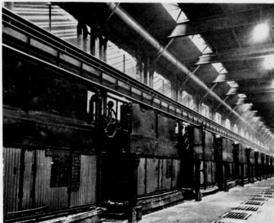
Une salle de cuves. Chacune de ces cuves peut produire 800 livres d'aluminium par jour.
