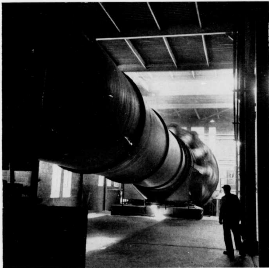
L'alumine combinée à l'eau est calcinée en une poudre blanche granulaire dans un de ces immenses fours rotatifs.
