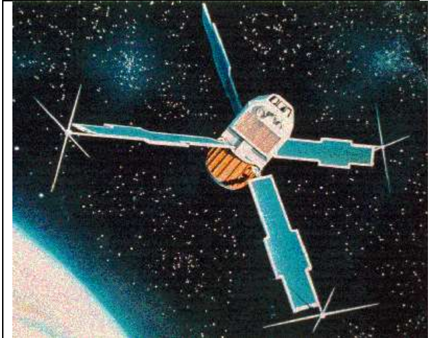
Le petit télescope spatial Uhuru était un cylindre de 56 cm de diamètre, mesurant 1,16 mètre de longueur et pesant 141,5 kg.
