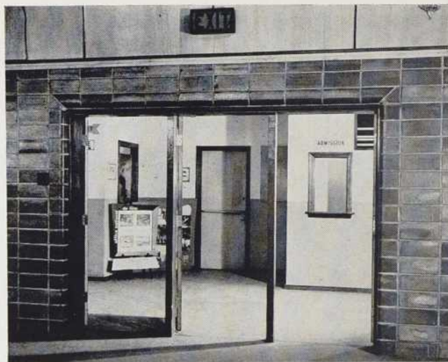
Vue de l'intérieur de l'auditorium vers le hall d'entrée. Revêtement des murs en tuile de brique et en contreplaqué de merisier.
