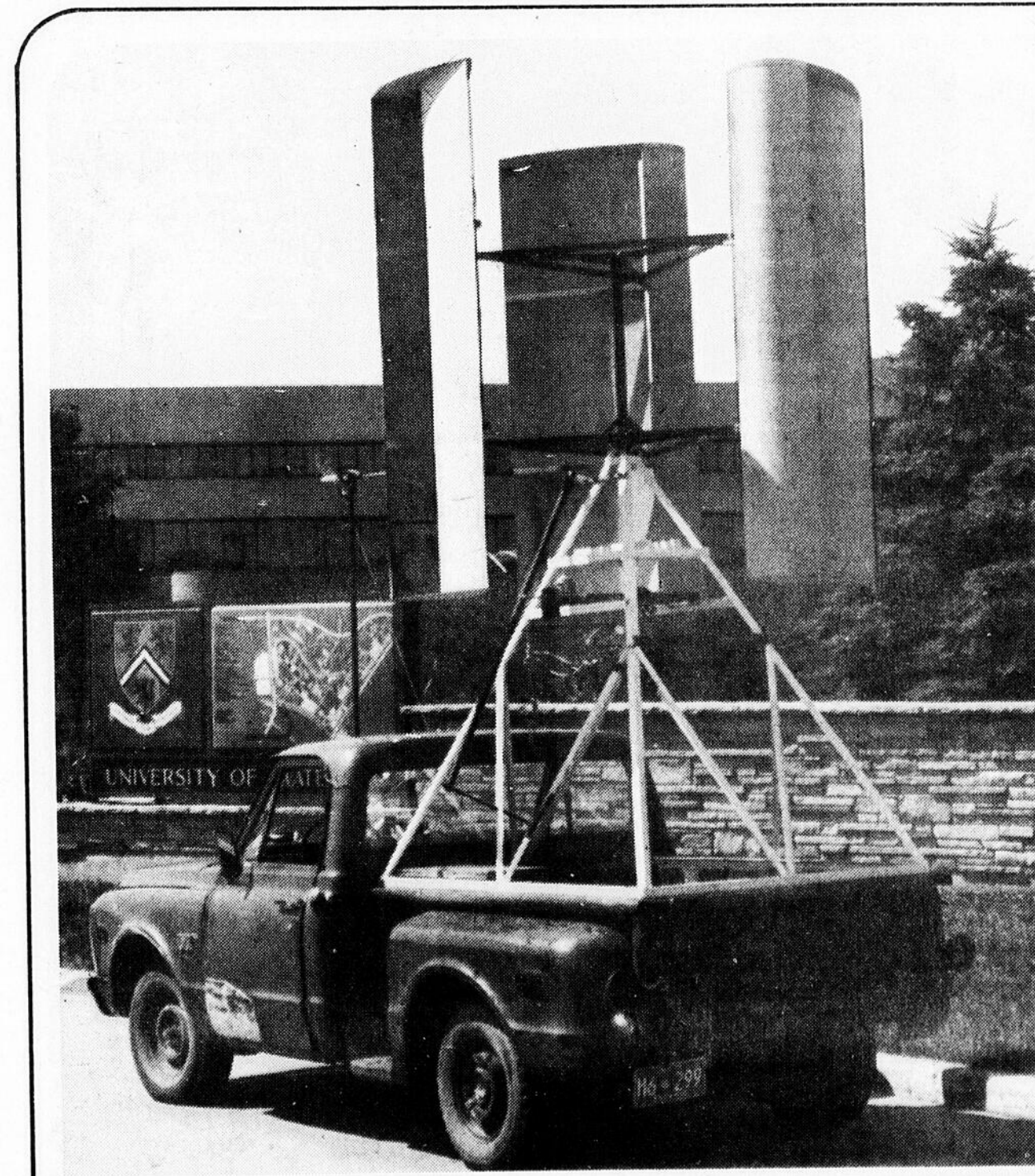
UN NOUVEAU MOULIN A VENT — Un nouveau type de moulin à vent, le "Filippini", subit un test à l'arrière d'un camion, sur le campus de l'Université de Waterloo. Quand on aura analysé les données fournies
