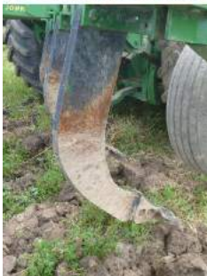
Figure 6. Effet de l'utilisation de dents droites sur engrais vert de seigle d'automne semé au printemps (a) et de dents incurvées sur engrais vert de trèfle après la récolte de blé en sol argileux (b).
