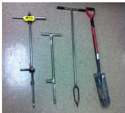
De gauche à droite: Pro-Sonde, sonde à bout creux, tarière et pelle à drain.
