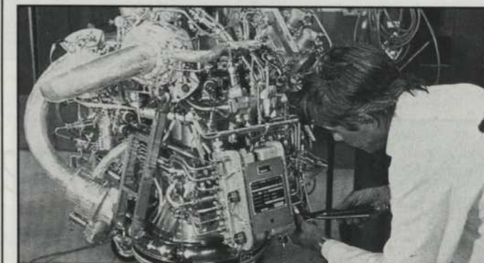
▼ Sep. Intégration du moteur du 3e étage à Vernon.
