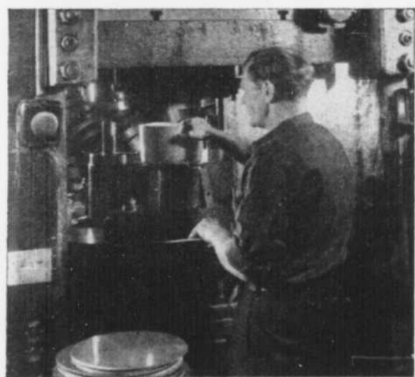
La haute pression fournie par de puissantes presses hydrauliques imprime à la feuille d'aluminium la forme originale de l'ustensile.
