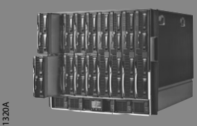
Boîtier HP BladeSystem contenant les serveurs lames BL460c et BL480c
