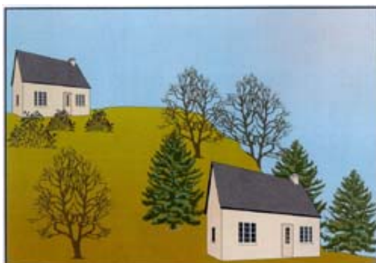
Les bâtiments ci-dessus respectent les conseils du PareFEU. Le bâtiment du haut est situé à au moins 10 mètres du bord de la pente. Quant au bâtiment du bas, celui-ci n'est pas jugé à risque parce qu'il est situé au bas de la pente.
