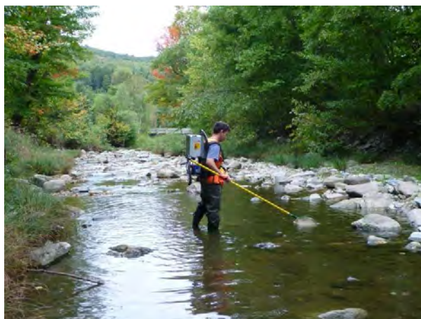
Figure 2. Technicien manœuvrant la pêcheuse électrique LR-24 de Smithroot
