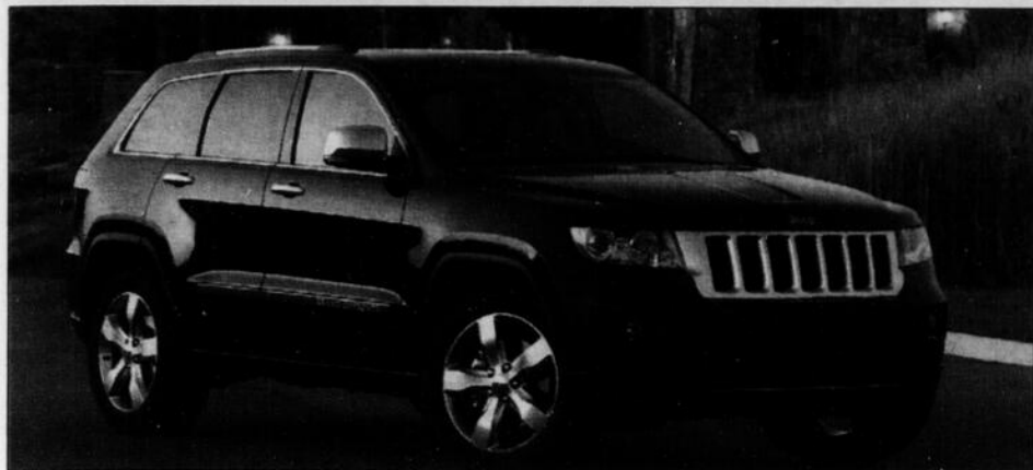
Le Jeep Grand Cherokee est un sérieux candidat au titre de «Camion Nord-Américain de l'Année». Malgré son châssis monocoque, il demeure un véritable baroudeur avec son rouage 4 roues motrices à 2 gammes de vitesses.
