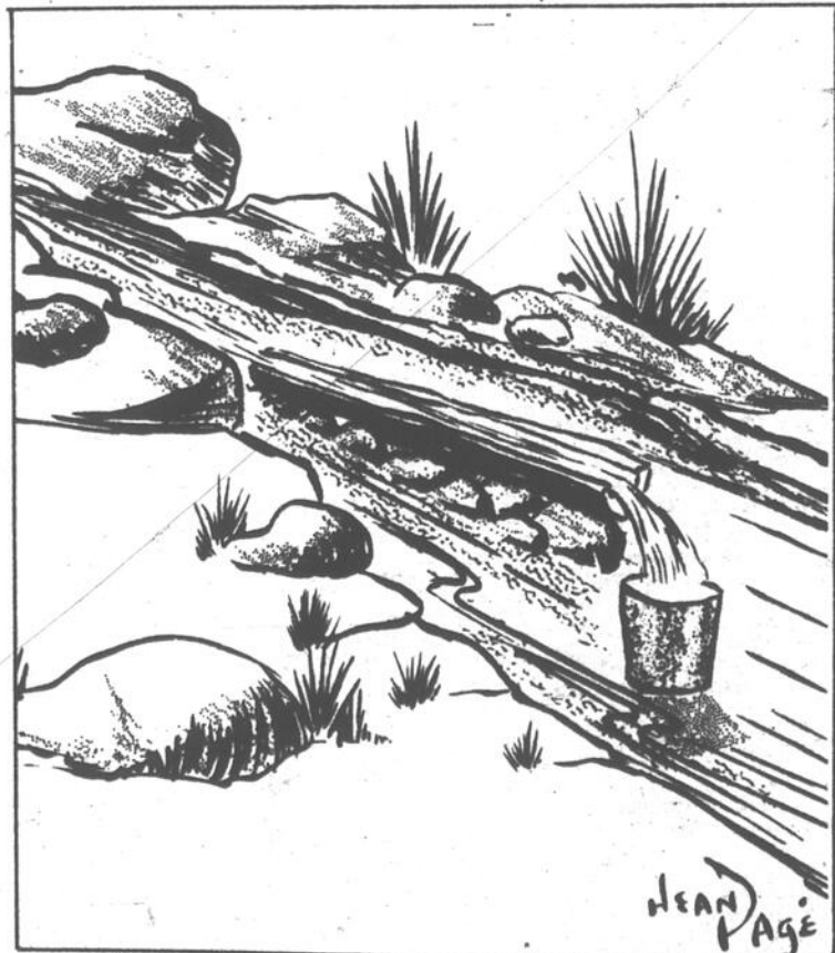
Pour obtenir facilement l'eau fraîche d'un ruisseau, placez un tronc d'arbre creux dans le courant comme l'indique la vignette.
