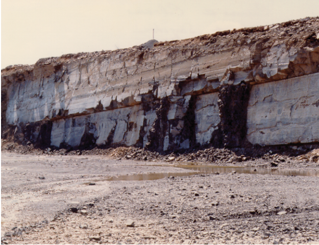
Photo 7 - Bancs épais et massifs de calcilutite à la carrière Lechasseur à Val-Brillant.
