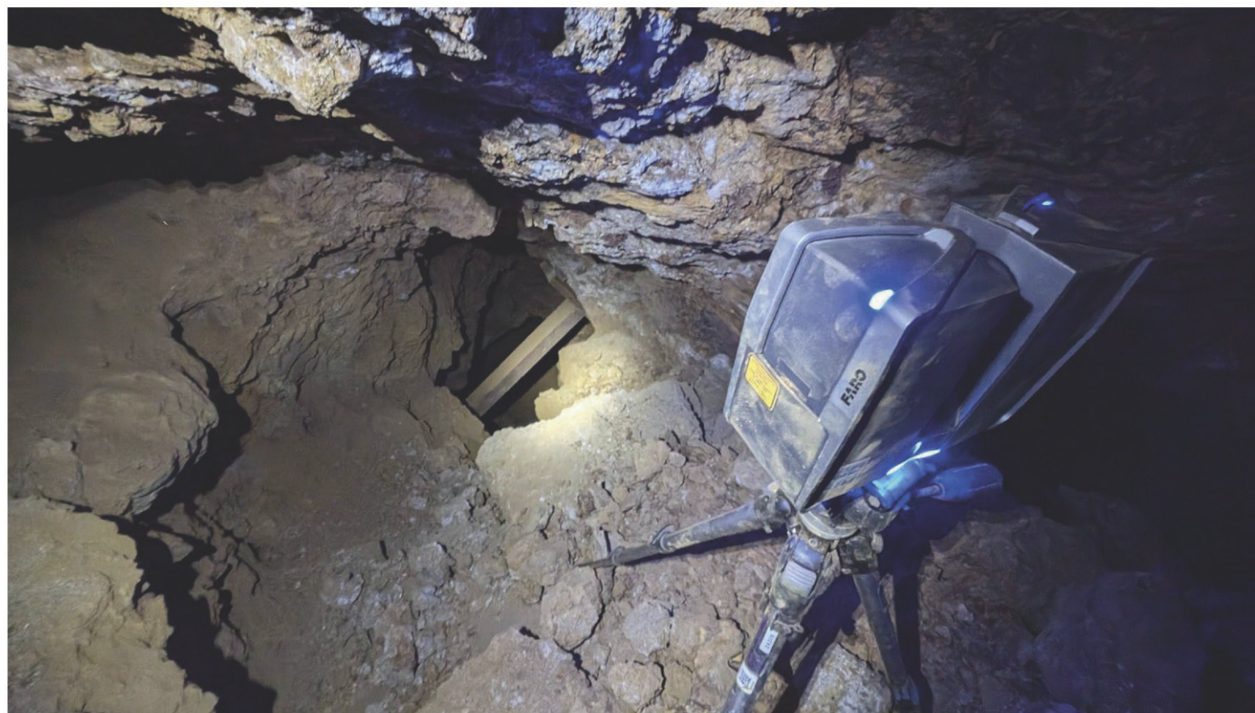
Le lidar est un numériseur laser 3D utilisé pour la télédétection et la cartographie. (Photo gracieuseté - Université Bishop's)
