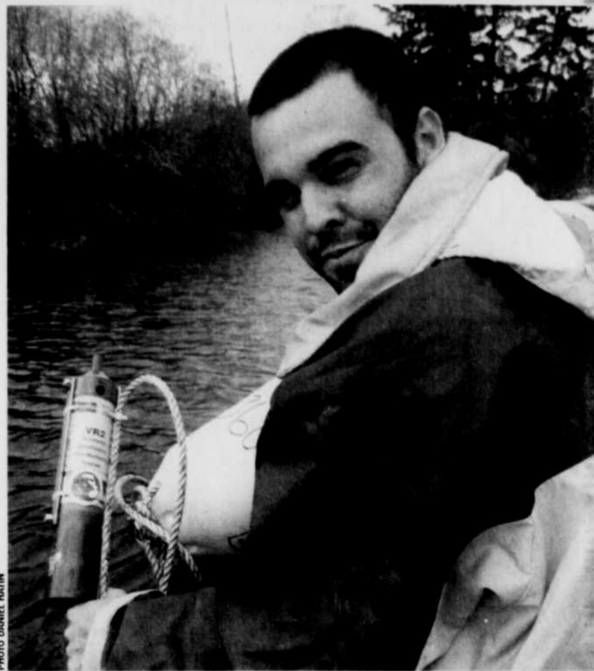
L'étudiant-chercheur François Martin installe l'un des récepteurs servant à suivre les déplacements des saumoneaux pendant leur migration vers la mer.
