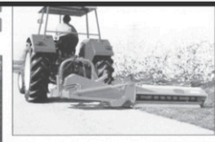
Faucheuses d'accotements pour travaux professionnels. Destinées à faucher et broyer herbes, ronces, fougères et autres végétations.
