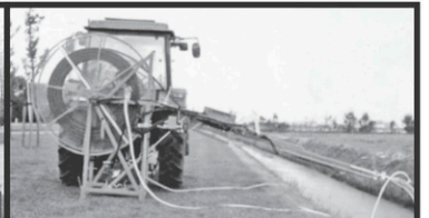
Nettoyeur HOMBURG à drain sous-terrain. Atteint une distance de 400 m
