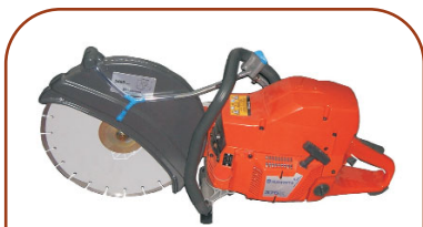
(1) Le système antivibrations isole les poignées provenant du moteur et de l'outil de coupe. Cette tronçonneuse, de marque Husqvarna, est également munie de ressorts pour contrer les vibrations.
