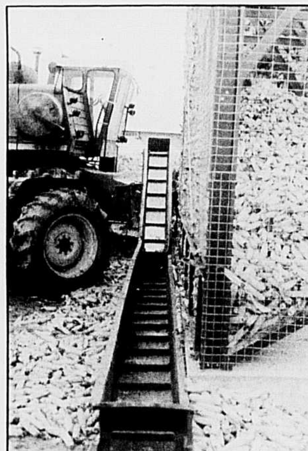
La trémie d'alimentation sur la moissonneuse-batteuse reçoit le maïs du convoyeur de vidange du crib et assure une alimentation régulière de la moissonneuse-batteuse.
