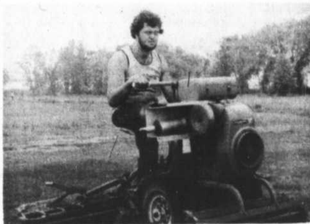
Le surintendant du terrain, M. Maurice Fleurent, est ici en train de couper l'herbe sur les départs. La machine qu'il opère présentement est munie de trois couteaux et sert à couper l'herbe sur les départs et autour des greens.
