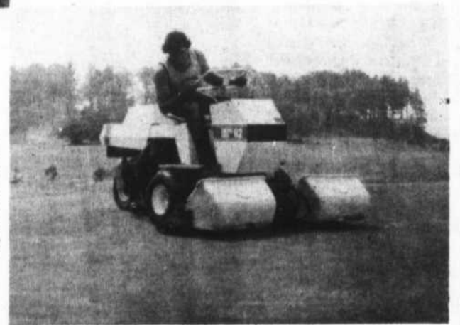
Cette machine valant plus de $10,000. sert à couper l'herbe sur les greens. Comme vous pouvez le constater sur la photo, les deux gros paniers à l'avant de la machine récupèrent la fine herbe coupée.
