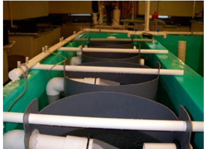
Photo 15 a. Bassin de grossissement de type downweller (haut) et jeunes myes dans ce type de contenant.
