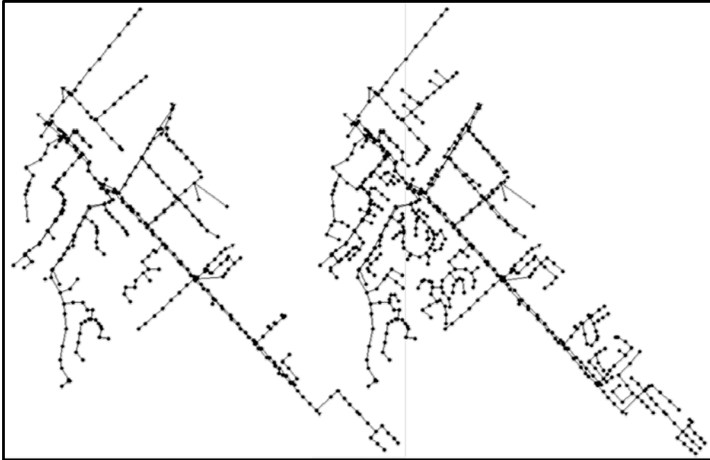
Figure 5.6 : Représentation du réseau A selon la représentation fournie par la ville à gauche et la représentation développée dans la présente étude à droite.
