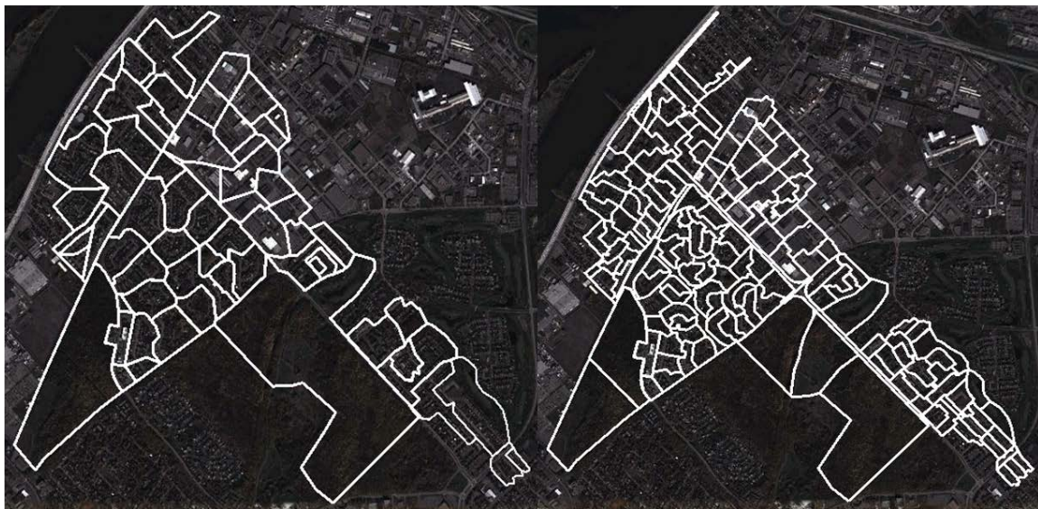
Figure 5.5 : Découpage du territoire en sous-bassins pour le secteur A (à gauche, la représentation d'origine fournie par la ville et à droite, celle développée dans le cadre de la présente étude).
