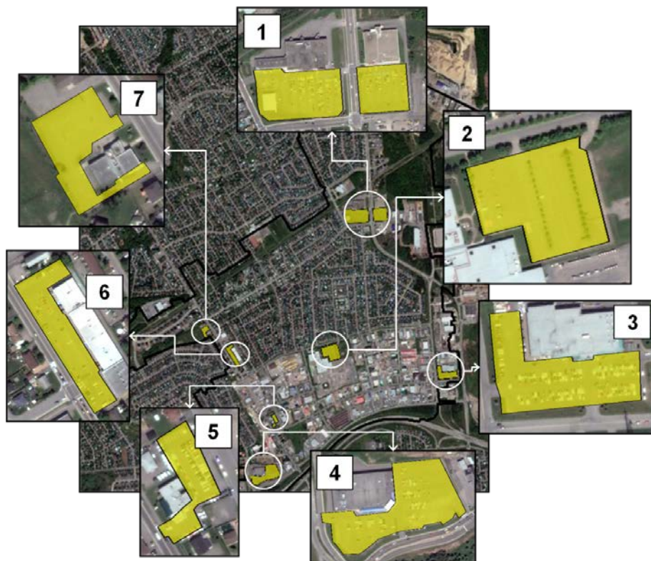
Figure 9.14 : Localisation des surfaces drainées par des systèmes de biorétention (scénario BIO1) pour le secteur D.
