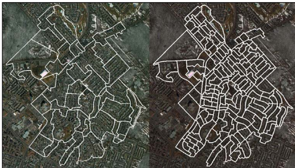
Figure 5.10 : Découpage du territoire en sous-bassins pour le secteur B (À gauche, la représentation d'origine fournie par la ville et à droite, la représentation développée dans le cadre de la présente étude après redécoupage du territoire).
