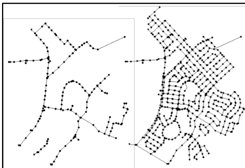
Figure 5.11 : Représentation du réseau de B selon la représentation d'origine fournie par la ville à gauche et celle développée dans le cadre de la présente étude à droite.
