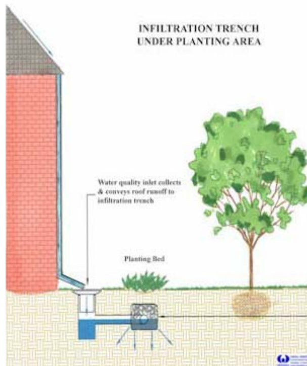
Figure 7.2 Tranchée d'infiltration avec conduites (tiré de DEP, 2006).
