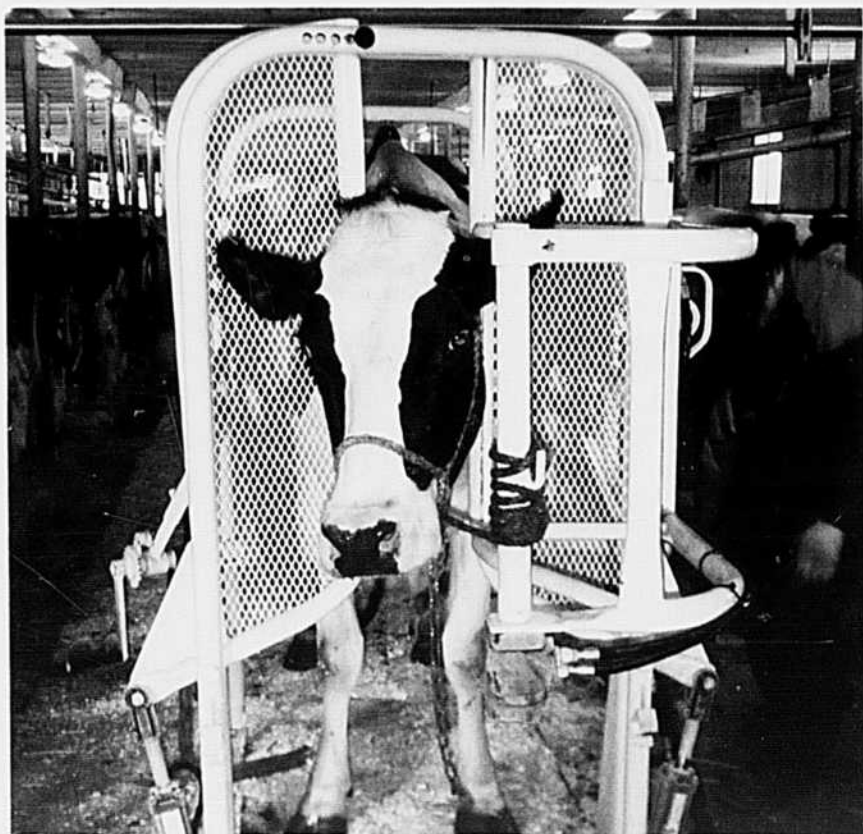
L'animal est tiré doucement dans la cage par un treuil hydraulique. Les portes se referment tout aussi délicatement. L'opérateur pourra ensuite sangler l'animal, le soulever de terre et procéder aux soins.
