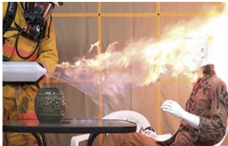
Simulation d'une mauvaise utilisation d'un foyer portatif.
