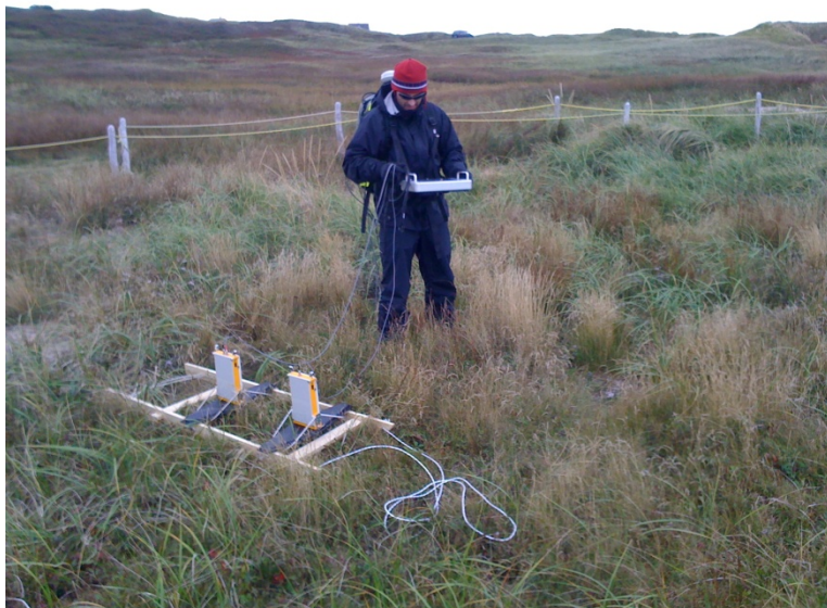
Figure 2 – Système radar ProEx avec antennes 200 MHz. L'unité principale d'acquisition est dans un sac sur le dos de l'opérateur. Un moniteur maintenu sur l'abdomen permet de contrôler les paramètres d'acquisition et de vérifier la qualité des données en temps réel.
