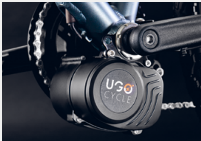
Moteur électrique développé par Ugo Cycle, spécialiste de la conversion de vélos analogues en vélos électriques.
