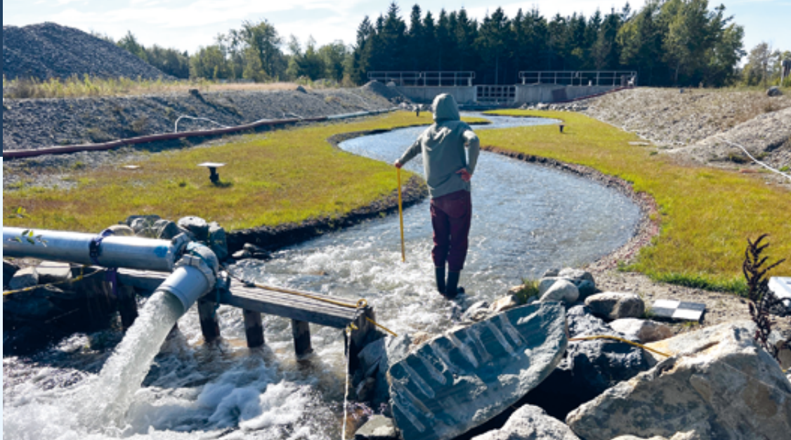
Rivière expérimentale développée par l'Université de Sherbrooke pour étudier les processus fluviaux.
