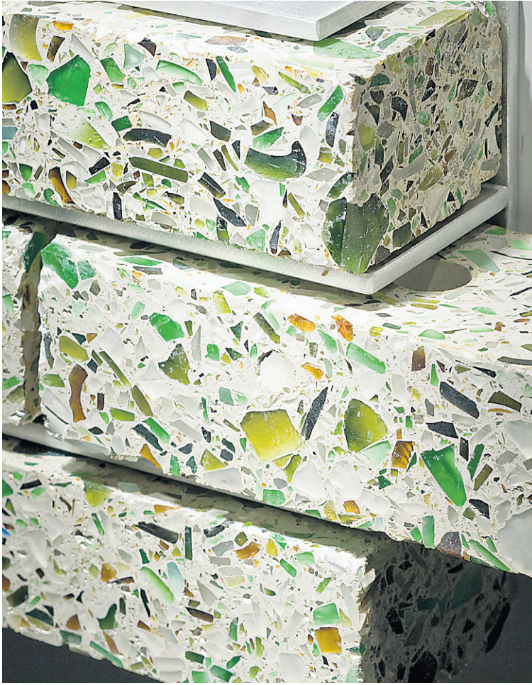
PHOTO FOURNIE PAR LE CENTRE DES SCIENCES DE MONTRÉAL Brique de béton et verre recyclé.
