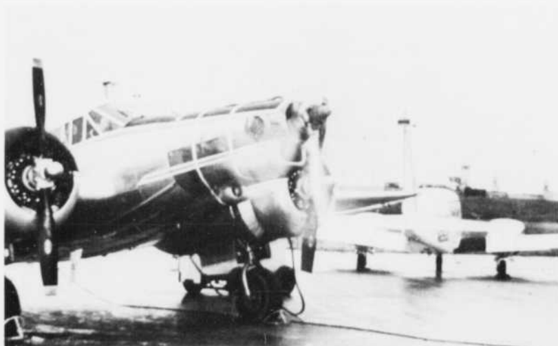
Le moteur PT6 sur son banc d'essai volant, le Beech 18 en 1961
