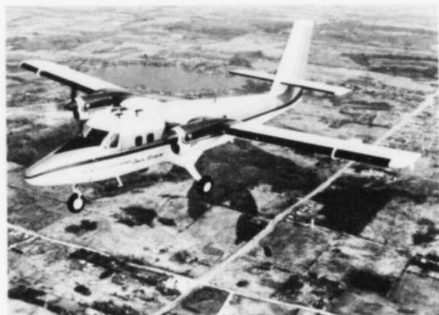
Twin-Otter de De Havilland propulsé par des PT6A-27
