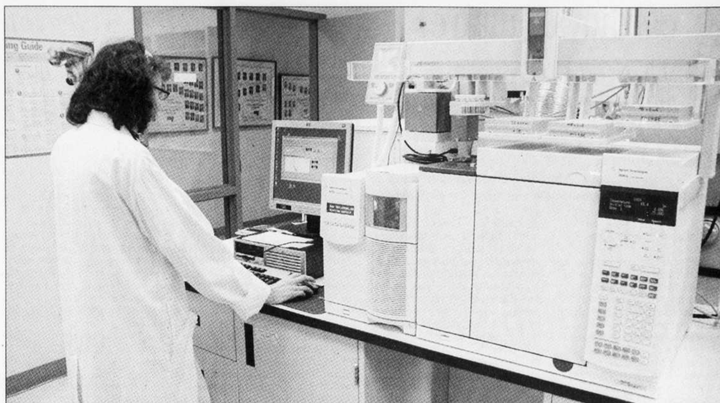
Le GSMS est un chromatographe en phase gazeuse (GC-MS) qui permet l'analyse de composés volatils. L'UQAM en a acheté un en 2007 au coût de 95 000 $.
