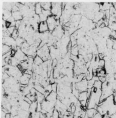
Fig. 3 — Acier 18-8 de type 347. (a) x 500, 3 heures à 1275°F; (b) x 500, 3 heures à 1275, puis 2 heures à 1950°F.
