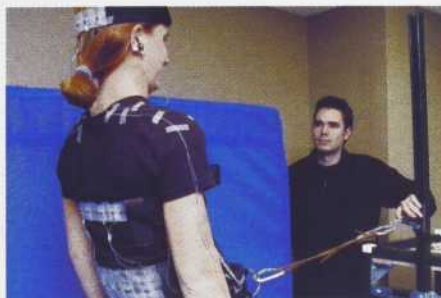
Photo de gauche, le chercheur Patrick Boissy (à l'avant-plan) et son équipe prennent des mesures afin d'évaluer les performances d'un détecteur de chute.
