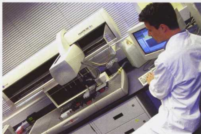
Afin d'identifier tous les gènes essentiels de la levure pathogène C. albicans , les chercheurs d'Elitra Canada effectuent des milliers de PCR (réactions en chaîne de la polymérase) par jour. Le robot manipulateur de liquides devient donc un outil essentiel dans le laboratoire!
