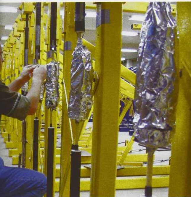
Tiges d'armature en matériaux composites, appelées à remplacer l'acier dans les structures en béton armé, et soumises à différents tests de vieillissement accéléré au laboratoire du Département de génie civil de l'Université de Sherbrooke. L'équipe du professeur Brahim Benmokrane obtient des données sur les caractéristiques à long terme des armatures en soumettant ces dernières à des températures extrêmes et en les exposant à des produits chimiques agressifs.
