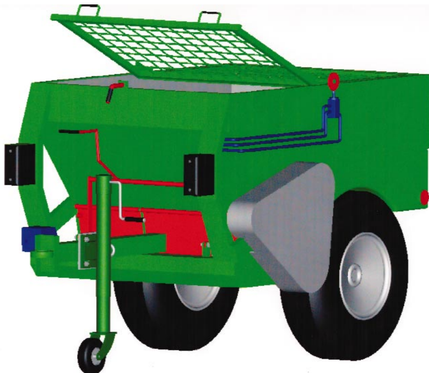
Figure 8: Une came sur la charnière le long de la largeur de la benne et un distributeur
