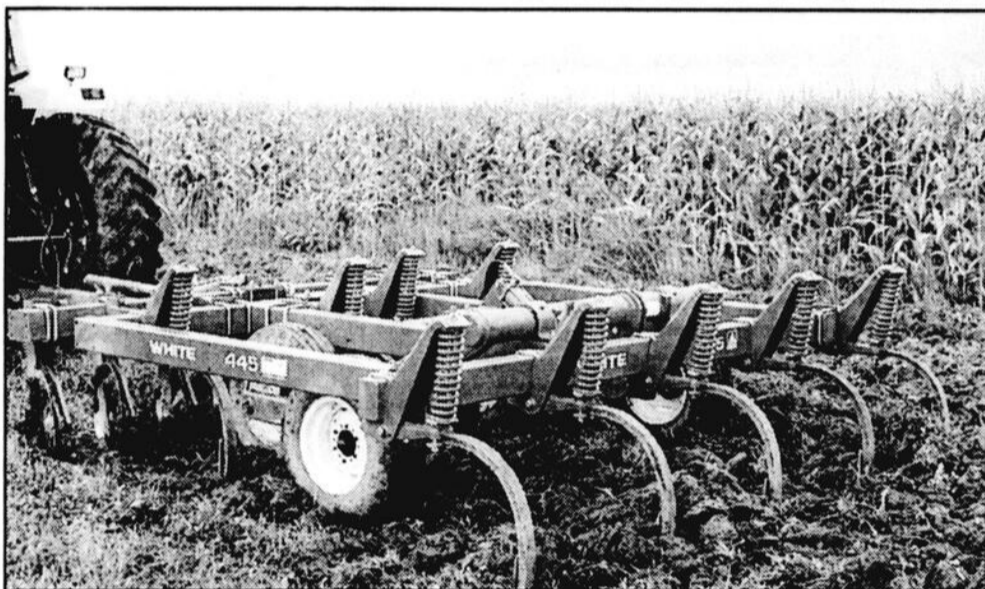
Les dents du chisel peuvent être munies de socs étroits (3 à 4 pouces de large) pouvant être concaves, plats ou vrillés. Mais les socs concaves (sur la photo) inversent plus le sol. (Photo : V.F.)
