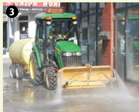
Un tracteur muni d'une citerne projette de l'eau sous pression sur toute la largeur du trottoir, repoussant les poussières et le petit gravier en bordure de rue.
