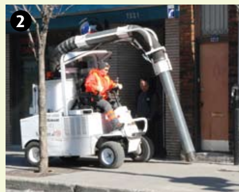
L'aspirateur de rue élimine les feuilles mortes, les papiers, les mégots de cigarettes et autres débris.
