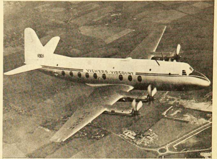
Le Viscount est fabriqué en Angleterre par la compagnie Vickers-Armstrong. Air-Canada a passé une commande de 15 de ces appareils qui lui seront livrés au cours de l'été 54 au prix de $765,000 pièce. Très élégant, le Viscount peut transporter 48 passagers plus une cargaison à une vitesse de croisière s'établissant entre 310 et 330 milles. Altitude de vol : 30,000 pieds ; pression intérieure maintenue à 4,000 pieds. Le Viscount est équipé de 4 moteurs Rolls-Royce de 1,400 cv chacun. Il s'agit de turbo-propulseurs, la turbine servant à entraîner une hélice. Air-Canada utilisera ses Viscount sur les lignes interurbaines.
