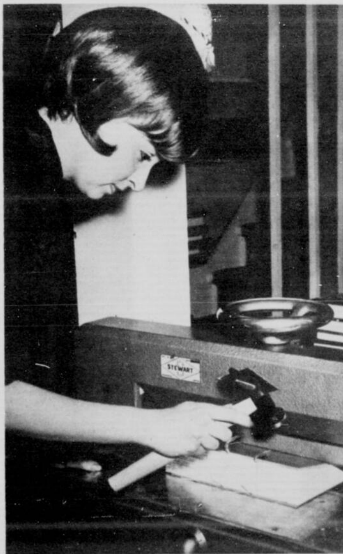
◁Et à coups de marteau, Mme Grégoire façonne le dos de son livre. On voit distinctement les ficelles, posées dans les encoches du grecquage. Elles sont indispensables.
