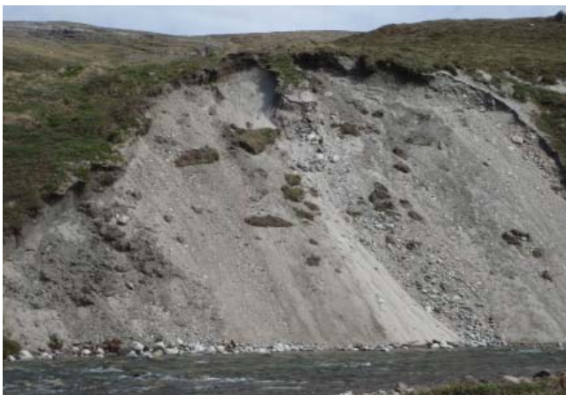
PHOTO 5 - Coupe naturelle de 8 m de hauteur composée de sable grossièrement stratifié renfermant des poches de gravier et de cailloux (site S4, gisement 2).
