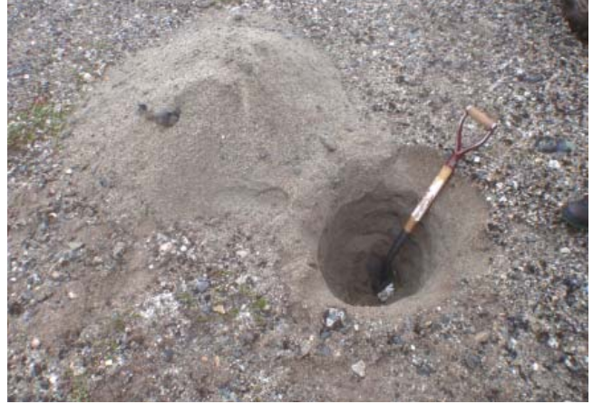
PHOTO 14 - Le sondage du site S30 a recoupé une zone de sable moyen à grossier renfermant moins de 5 % de gravier et très peu de particules fines (gisement 8).
