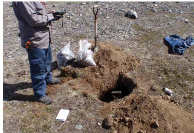
PHOTO 29 - Le sondage du site S50 a recoupé une zone de sable moyen à grossier contenant 15 à 25 % de gravier. L'échantillonneur prélevé à ce site a été enrichi en gravier pour des fins d'analyse.
