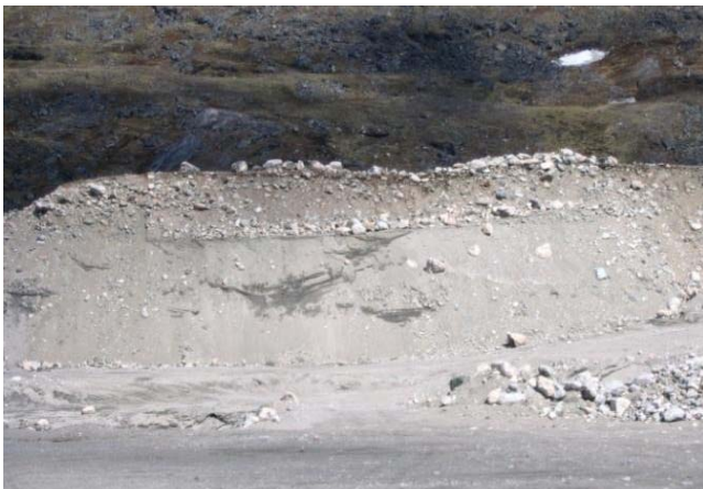
PHOTO 17 - Le gisement 9 est la principale source de granulats du village de Salluit. La proportion de gravier et de cailloux passe de 50 à 70 % en surface à moins de 15 % en profondeur.
