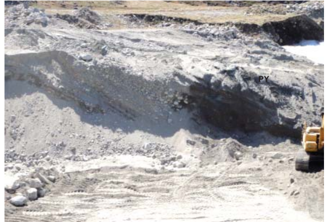
PHOTO 16 - La coupe 2 du site S33 atteint 4 à 5 m de hauteur et présente des stratifications obliques. Les lits sont composés de sable graveleux et de gravier avec cailloux (gisement 9).
