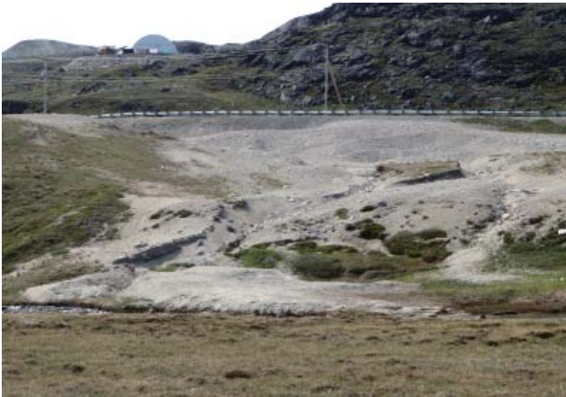
PHOTO 9 - Exploitation abandonnée en bordure du chemin de l'aéroport. Dépôt deltaïque de 6 à 8 m d'épaisseur composé de sable moyen à grossier faiblement graveleux (site S24, gisement 6).
