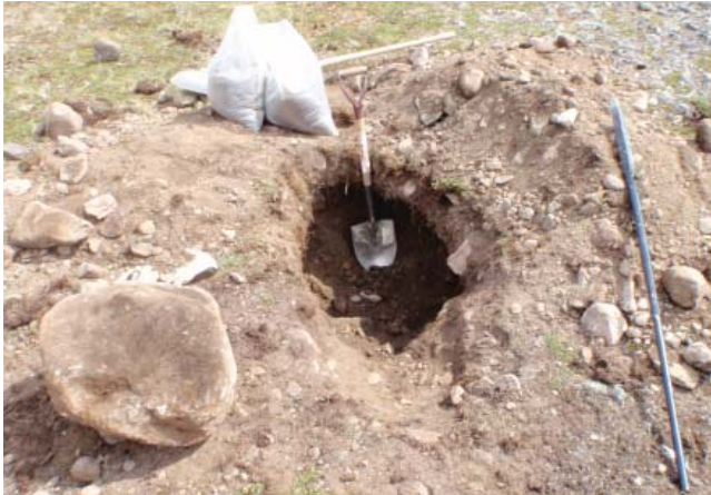
PHOTO 26 - Le sondage du site S40 a traversé une zone composée de sable moyen à grossier contenant 45 à 55 % de gravier et des cailloux.
