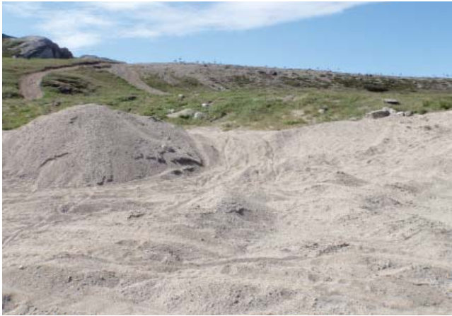
PHOTO 3 - Dépôt fluvioglaciaire constitué de plus de 8 m de sable graveleux. Cependant, ce dépôt a été classé 3 en raison de la présence du cimetière en surface (site S2, gisement 1).
