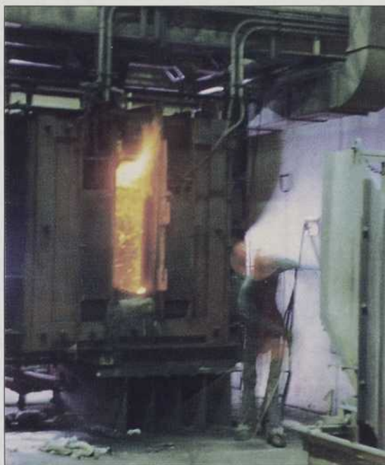
Un des fours à coke du laboratoire fédéral. On vient d'en enlever les portes pour procéder au défournement du coke.
