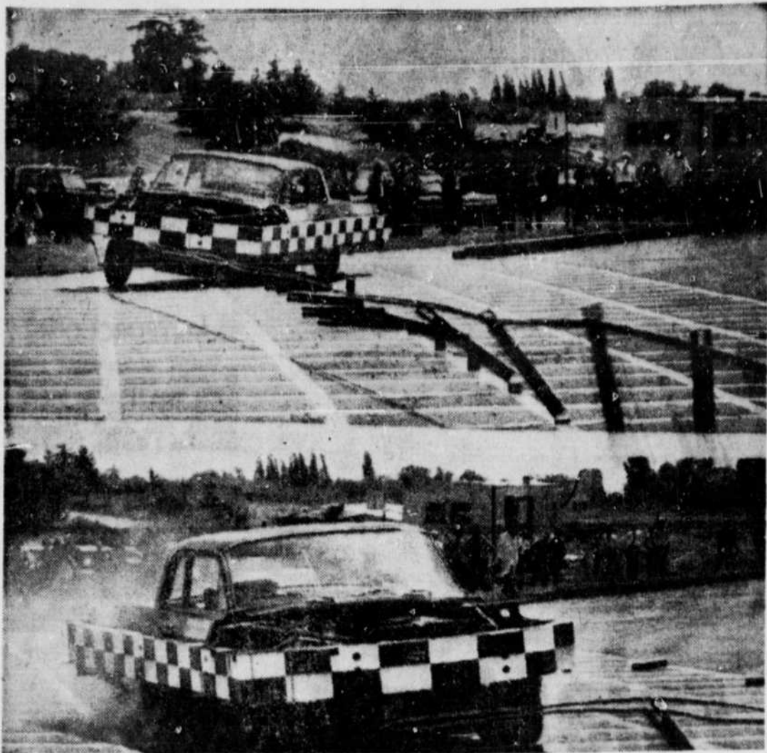
● Le Conseil national canadien de la recherche est à mettre au point une clôture de sécurité. Cette clôture, faite de supports d'acier et d'un double câble élastique a fait ses preuves en Angleterre. Cet auto, alourdi de plaques d'acier, est allée s'y arrêter à plusieurs reprises sans dommage. (Téléphoto U.P.I.)
