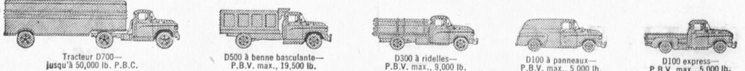
Tracteur D700—jusqu'à 50,000 lb. P.B.C. D500 à benne basculante—P.B.V. max., 19,500 lb. D300 à ridelles—P.B.V. max., 9,000 lb. D100 à panneaux—P.B.V. max., 5,000 lb. D100 express—P.B.V. max., 5,000 lb.
