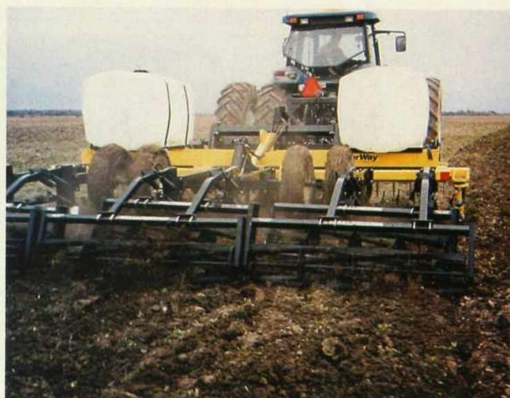
L'utilisation de réservoirs d'eau permet d'ajuster le poids facilement sur le AerWay.
