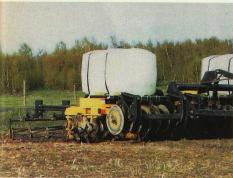
Le AerWay peut aussi être équipé de disques à l'avant pour couper les résidus et de rouleaux émotteurs à l'arrière.
